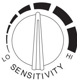
Před svařováním nastavte citlivost na vysokou hodnotu, při střetu s osvětlením (filtr se zatemní, aniž se svařuje), upravte citlivost na nižší
